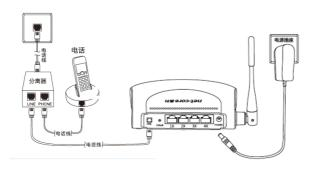
按照上图所示,正确连接各设备,开启 ON/OFF 开关,待指示灯处于正常状态时(详情见产品指示灯说明),说明 Modem 已经开始正常运行。
